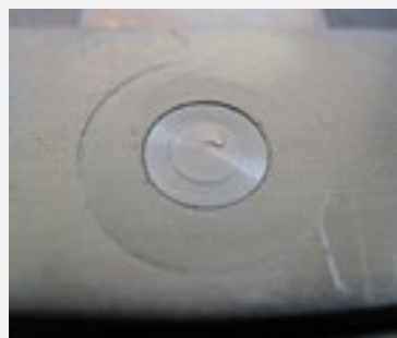
a) Orodje za točkovno FSW; b) točka; (C) točkovni FSW izdelek
