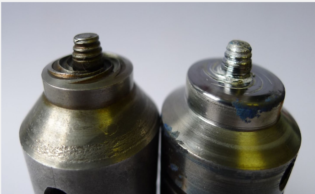
Obrabljena orodja iz jekla tipa 19554 (H13)
