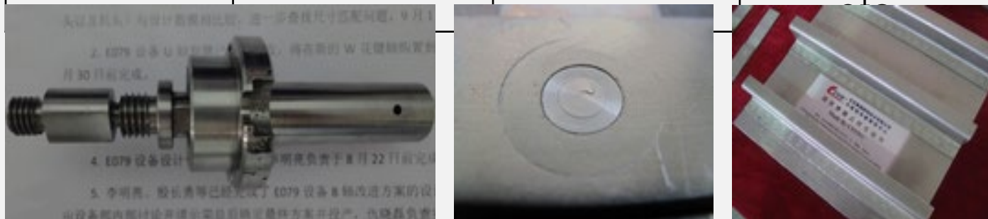
a) Nástroj na bodové FSW; (b) Vzhľad bodového FSW spoja; (c) Bodový FSW produkt pre letectvo
