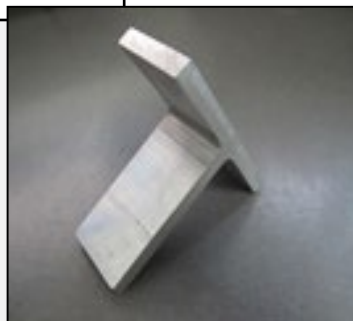
8 mm hrubá vzorka šva zvárená FSW procesom so stacionárnym ramenom
