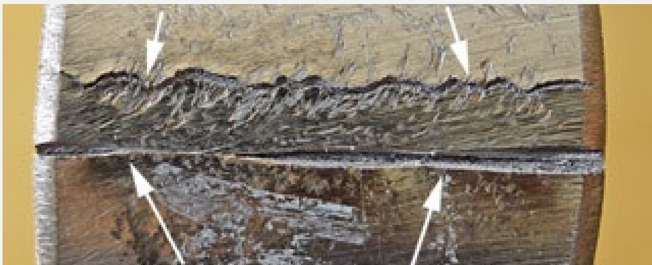
Identifikovaná prasklina vo zvarovom spoji po skúške ohybom
