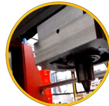
Infrastructura /masina FSW
