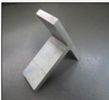
Imbinare in colt cu grosimea componetelor de 8 mm, aliaj de Al, sudată FSW cu umar staționar
