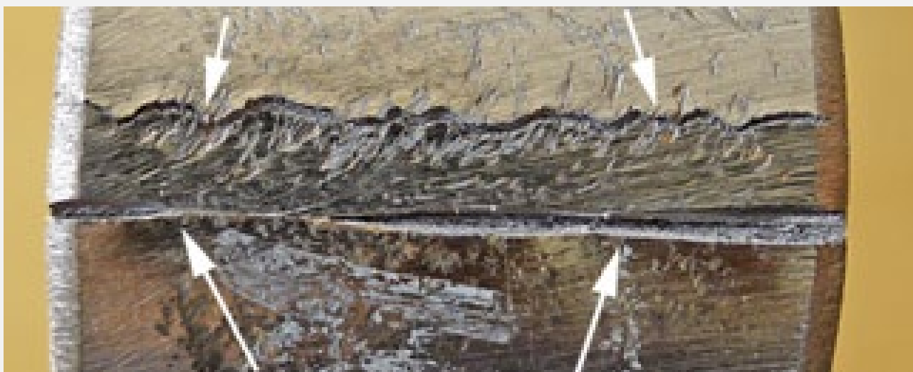
Fisură apărută în îmbinare după testul de îndoire longitudinală
