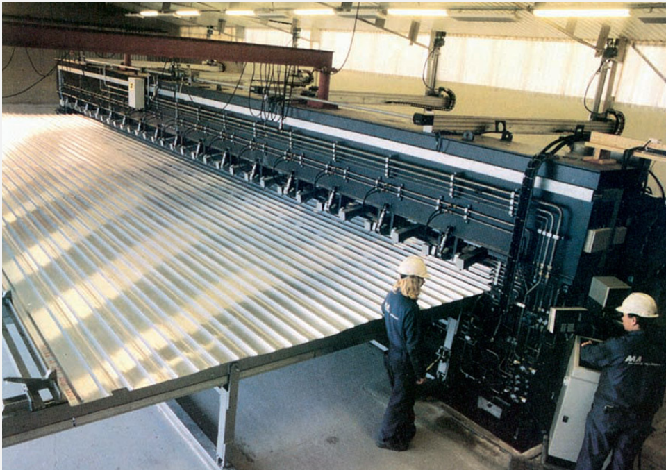
Constructii navale – panou de dimensiuni mari sudat FSW
