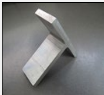
Liga de AL com 8mm de espessura Amostra com soldadura de canto ligada pelo processo SFL com base estacionária
