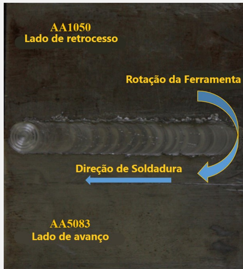
Detalhes relacionados com a rotação da ferramenta e direção de soldadura
