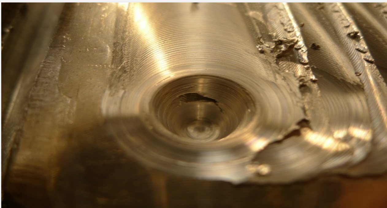
Cavidade longitudinal na junta soldada constituída por Al puro 10 mm de espessura
