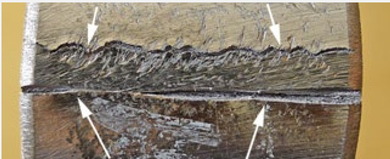
Fissura identificada na junta soldada após o teste de dobragem
