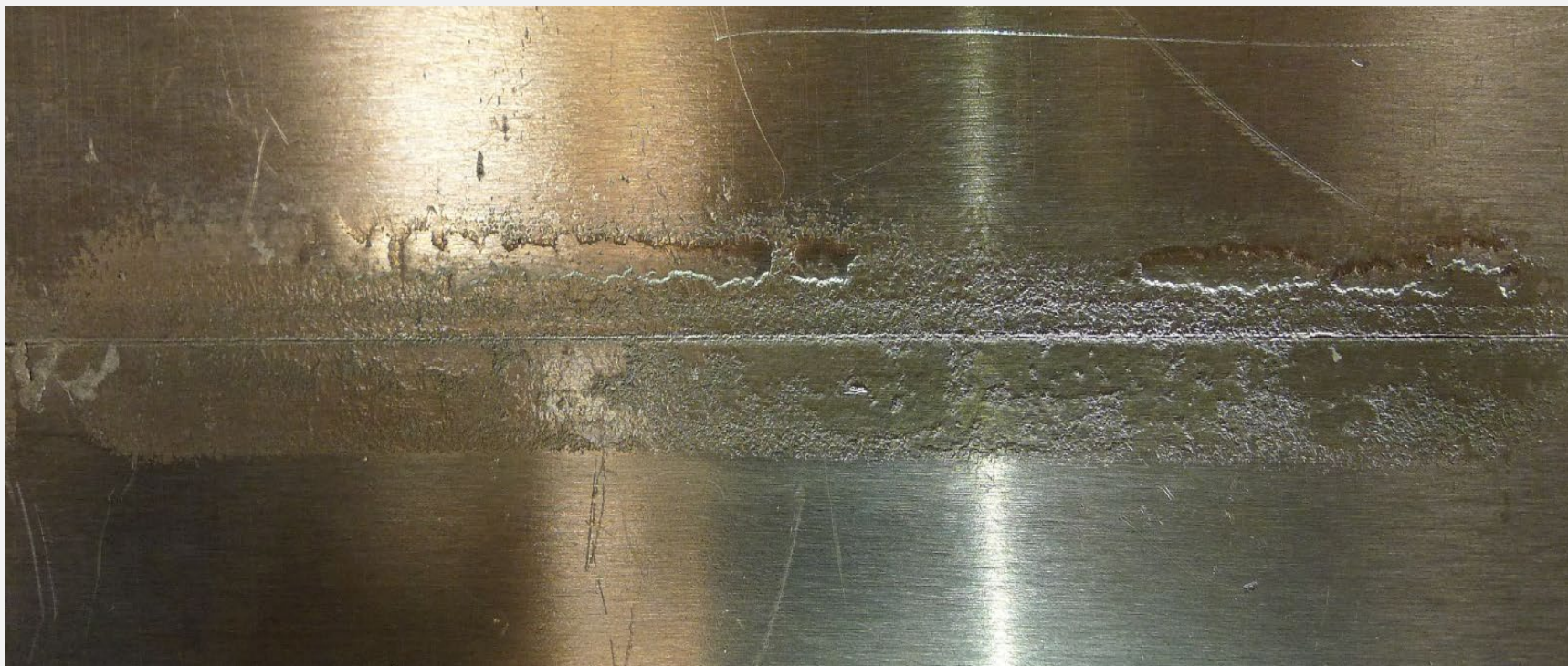
Raiz insuficientemente processada da junta soldada
