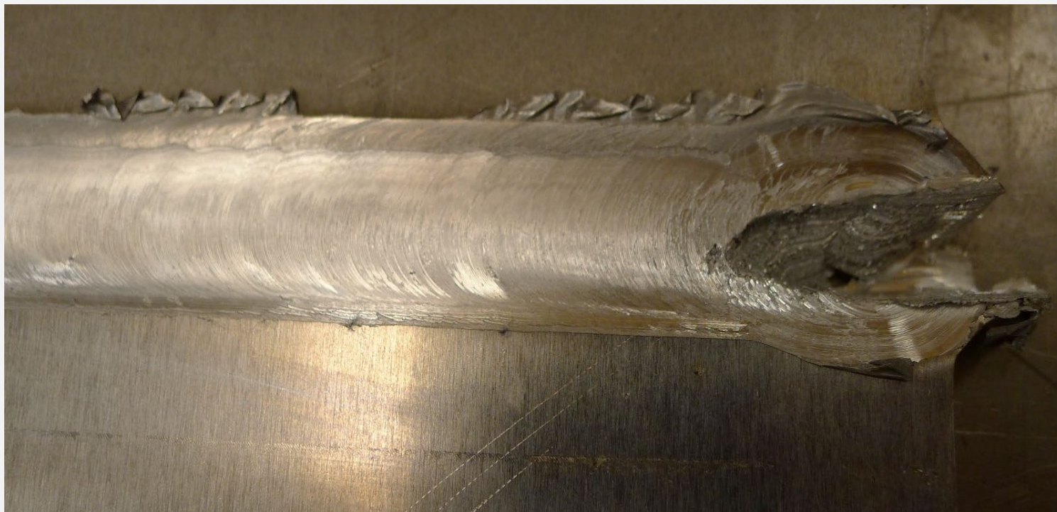
Marca da ferramenta de soldadura sem uma placa sacrifício
