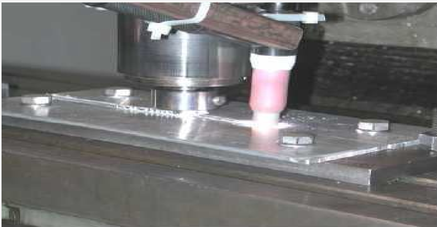
HFSW zariadenie s účasťou GTAW zdroja tepla
