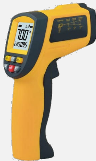
Pirometru - pentru verificarea rapidă a temperaturii piesei
