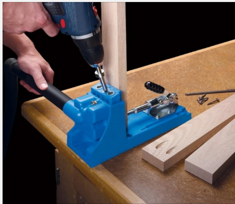
Montaj pentru gaurire (Courtesy of Kreg)
