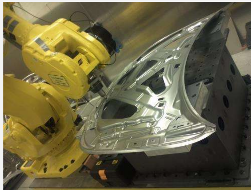
Sudarea FSW robotizata a unui element de caroserie auto
