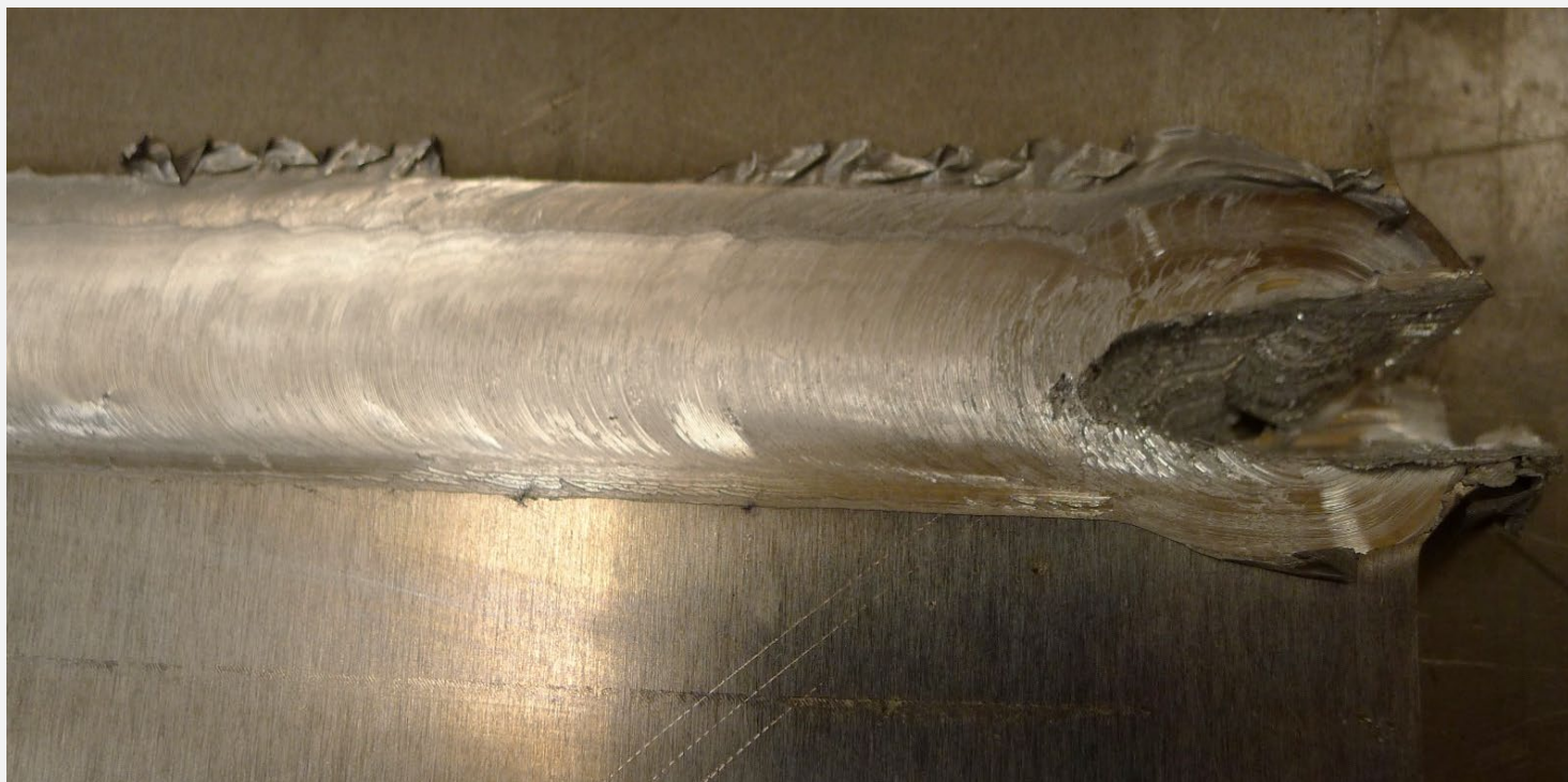
Keyhole /marcação deixado pela ferramenta de soldadura
