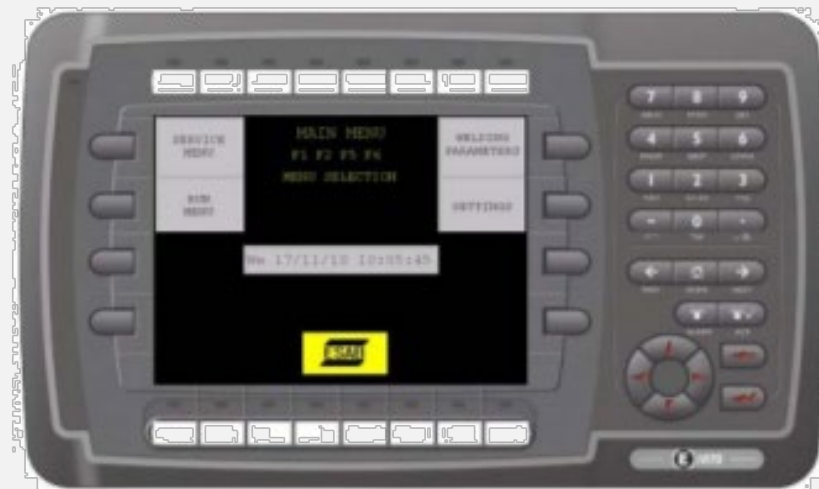
Sistema de controlo desenvolvido para o SFL (Cortesia da ESAB)
