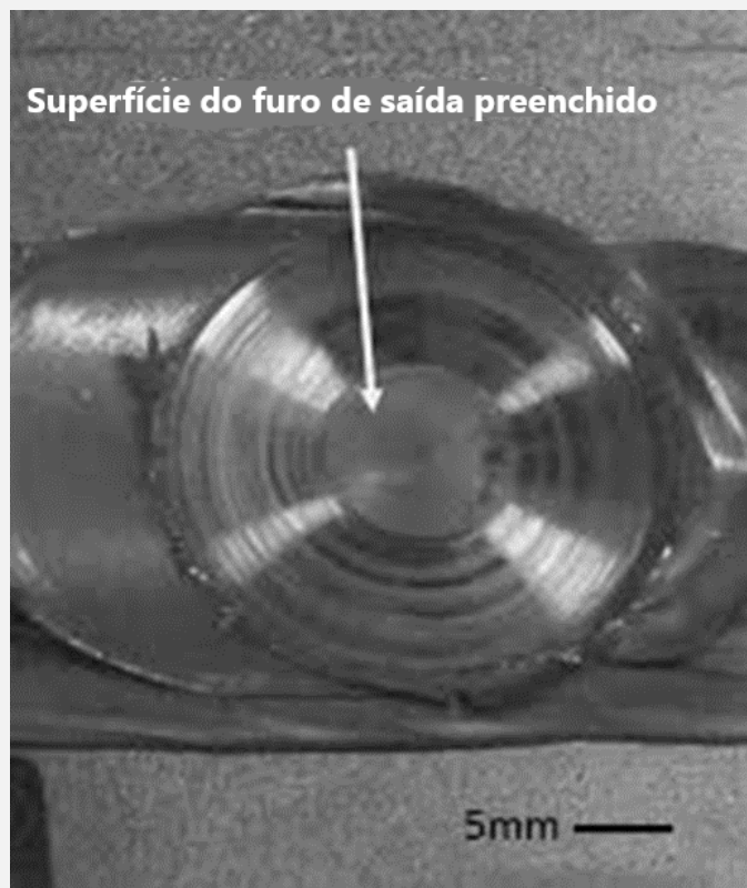
Superfície com o furo de saída preenchido
